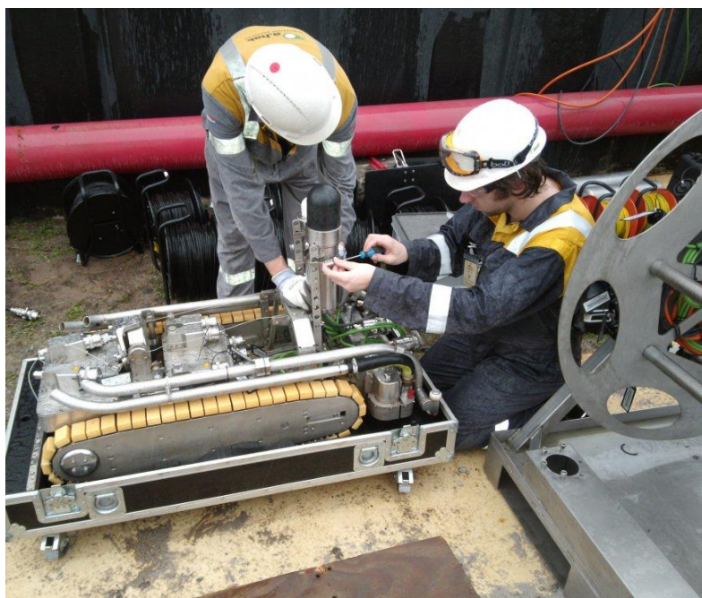
Figura 3 - Robô para Inspeção de Píer
